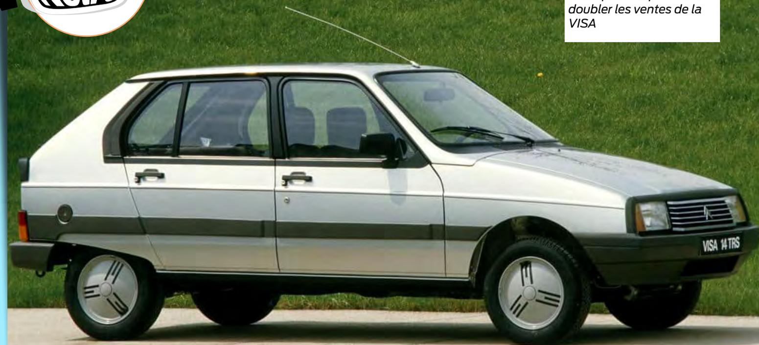
En mars 1984, Citroën présente la Visa Diesel qui reçoit le moteur de la Peugeot 205. Celui-ci impose de monter un train avant plus large qui va nécessiter d'installer des protections plastiques sur les passages de roues pour recevoir ce train avant plus large.
