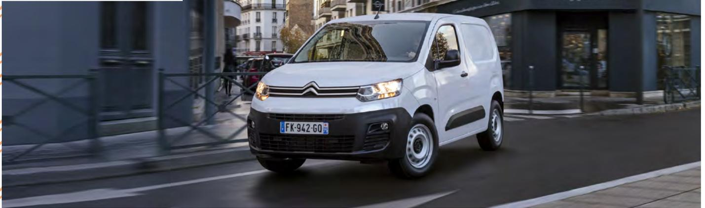
Après les Jumper et Jumpy, Citroën présente le nouveau ë-Berlingo van permettant de proposer l'ensemble de sa gamme utilitaires avec une version électrique. A l'image de la version familiale, le Citroën ë-Berlingo reprend la chaîne de traction électrique de la nouvelle C4 soit un moteur de 136 chevaux associé à un batterie de 50 kWh pour un autonomie allant jusqu'à 275 kilomètres.
